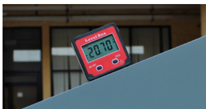
Fig. 20 Inclinómetro usado para verificar que el borde superior del gnomon formara un ángulo de 20.7^\circ con respecto al plano horizontal.
