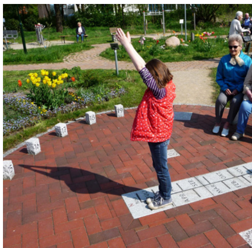
Fig. 3 Reloj solar analemático instalado en Nienhagen, Alemania. Los visitantes hacen la función del gnomon , parándose sobre la carátula en el sitio adecuado según la fecha, de manera que su sombra es la que marca la hora. Diseño: Siegfried Rasper.
