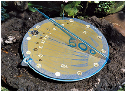
Fig. 4 Reloj solar horizontal que indica la hora solar del sitio de colocación (números romanos), así como la hora solar del meridiano ( 90^\circ O) que rige la hora en la Ciudad de México. Pueden distinguirse un analema alrededor de la marca del mediodía solar , los signos del zodiaco en la periferia, así como una brújula en el extremo norte de la carátula. Diseño: Lothar M. Loske.
