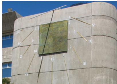
Fig. 5 Reloj solar vertical declinante con un gnomon de 3.3 metros, instalado en el Centro de Nanociencias y Nanotecnología de la UNAM en Ensenada, BC. La pared donde se trazó el reloj no está orientada exactamente hacia el sur, sino que declina más de 8 grados al este, razón por la que las líneas de las horas no son simétricas. Diseño: Roberto Machorro.
