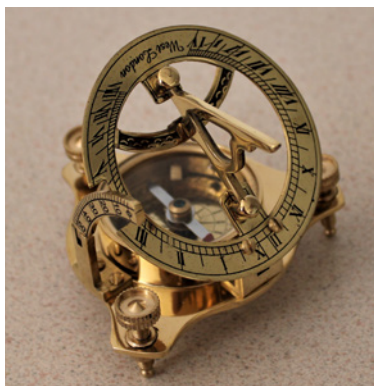
Fig. 7 Reloj solar portátil de latón (diámetro aproximado 10 cm). Puede determinarse la hora solar orientando el gnomon con la brújula y ajustando el ángulo de la carátula.
